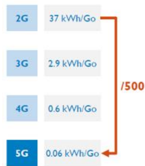
Consommation électrique en kWh/Go des réseaux mobiles
